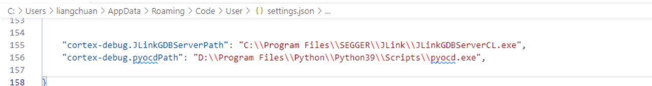
图 4-6 Cortex-Debug 插件配置驱动路径示例 (Windows)
