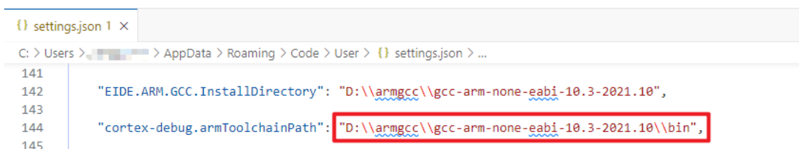
图 2-10 Cortex-Debug 插件配置 json 文件 (Windows)
