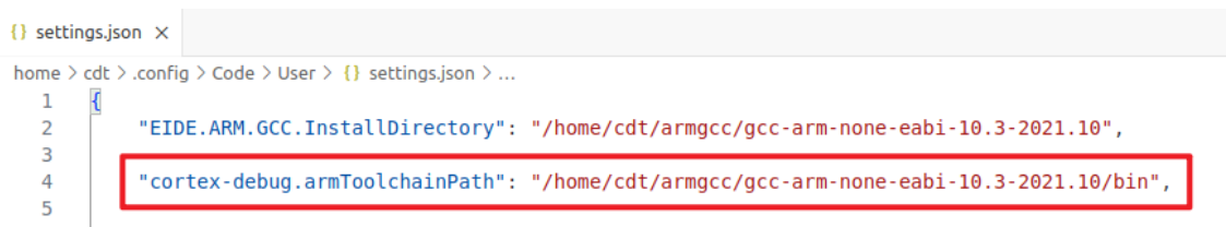
图 2-11 Cortex-Debug 插件配置 json 文件 (Linux)
