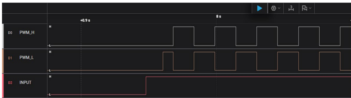
图 3-4 PWM 恢复互补波形后，EMB 控制 PWM 恢复输出
