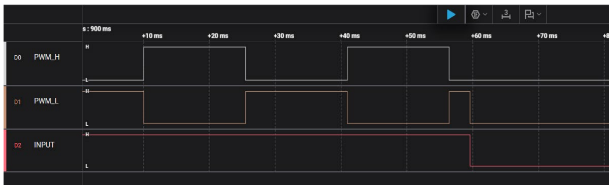
图 3-1 外部端口电平有效时，EMB 控制 PWM 停止输出
