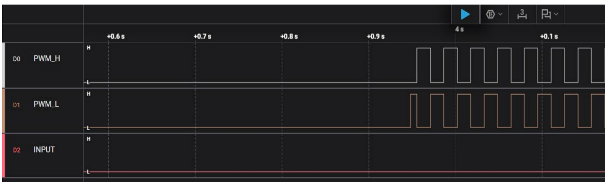
图 3-6 CMP 输出无效时，EMB 控制 PWM 恢复输出
