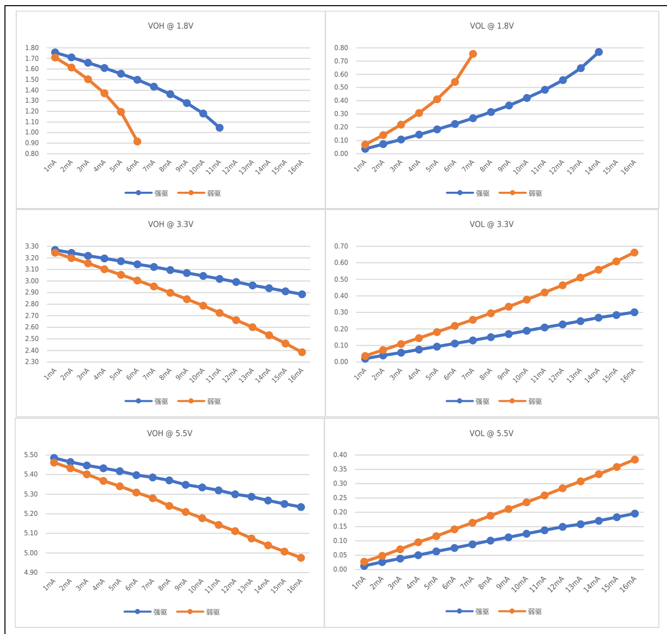
图 7-2 输出端口 VOH/VOL 实测曲线
