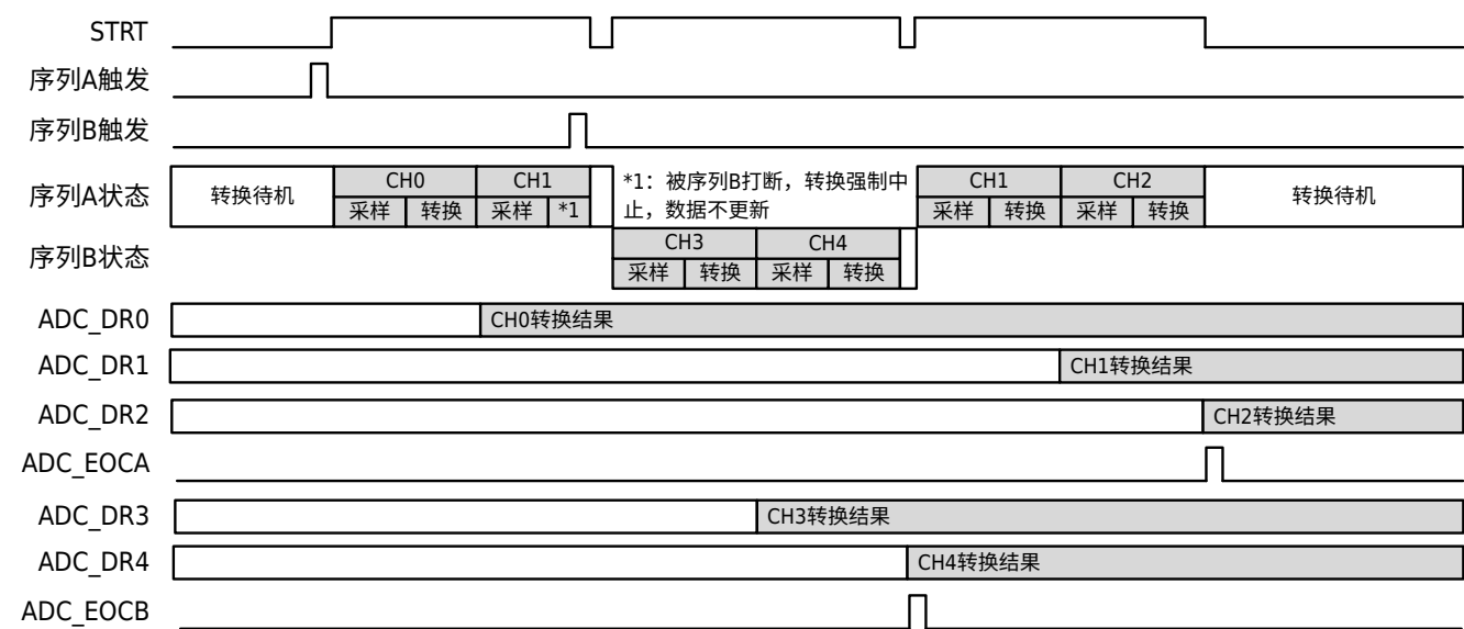
图 18-7 双序列扫描模式 (序列 A 从被中断通道重新启动)
