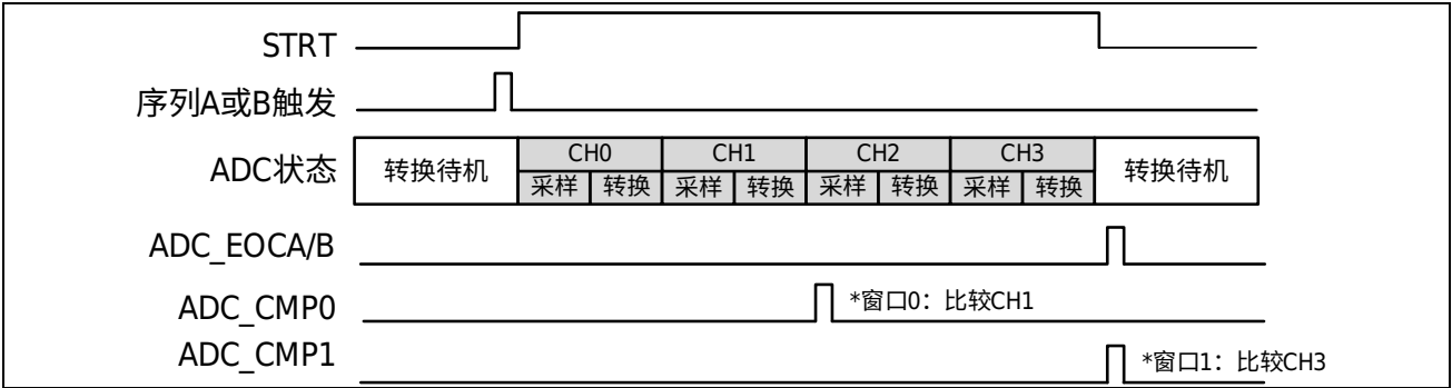
图 13-9 ADC 中断和事件输出时序
